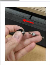
INSERT THE MILLING BIT INSIDE THE COLLET
